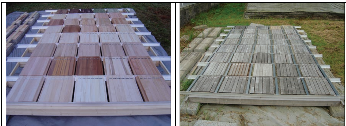
Bilde 2.5 Norske løv- og bartrær i over bakke-testing i Fana ved Bergen, et samarbeidsprosjekt mellom Skog og landskap og NTI. Vi ser at etter ett års eksponering er mange av fargeforskjellene mellom treslagene borte. Foto: Per Otto Flæte.
